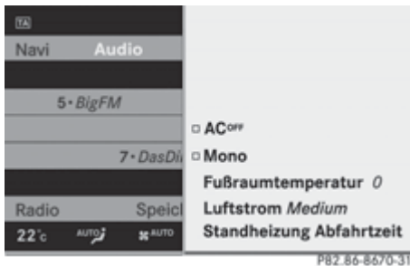
Zentralmenü der Klimatisierung
